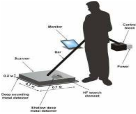
Şekil 6. Metal dedektörün yapısı
